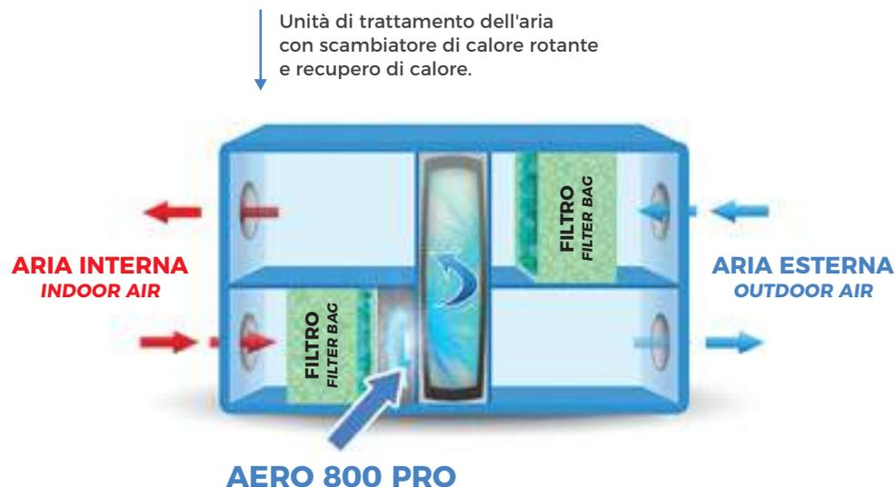
Oltre a mantenere le canalizzazioni pulite da batteri, virus, muffe e odori, consente anche un **notevole risparmio energetico**. Allo stesso tempo **si evitano** possibili problemi dovuti a eventuali **perdite** nello scambiatore di calore, poiché, rimanendo pulita l'aria, i filtri non si intasano.
